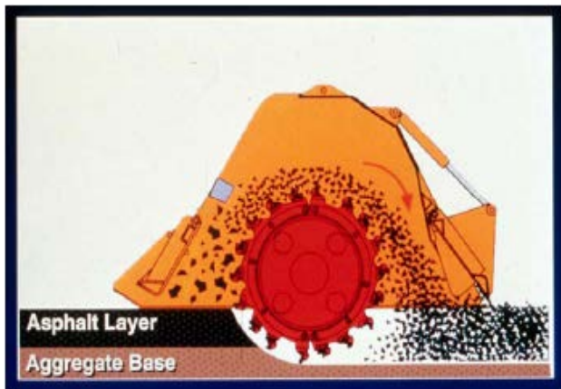
Figure 1. Graphique du procédé de recyclage en place. (Graphique gracieusement fourni par ARRA)
